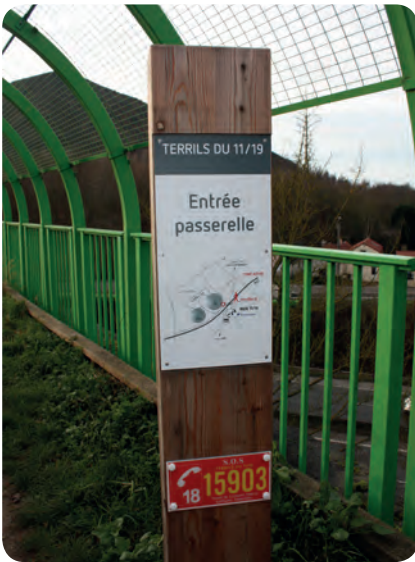
Les Services Départementaux d'Incendie et de Secours proposent d'installer sur les sites des bornes de localisation. Il est recommandé d'intégrer les plaques d'information aux panneaux du site et d'expliquer le dispositif sur les panneaux d'entrée de site. Mission Bassin Minier
